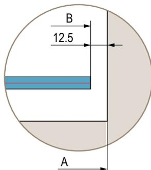
**Dimensions à carreler pour pose sur douche à l'italienne d'une paroi standard**
