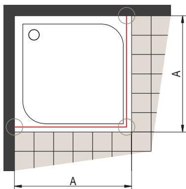
**A** | Dimension mesurée du mur, carrelage posé, au bord extérieur du receveur.
