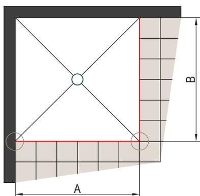
**A-B** | Dimensions mesurées du mur, carrelage posé, à la position réelle de la paroi.
